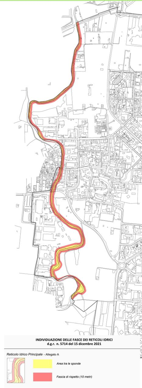
**Dettaglio Pericolosità idraulica T10 - H3 e H4 (fonte Studio comunale di gestione del rischio idraulico)**
