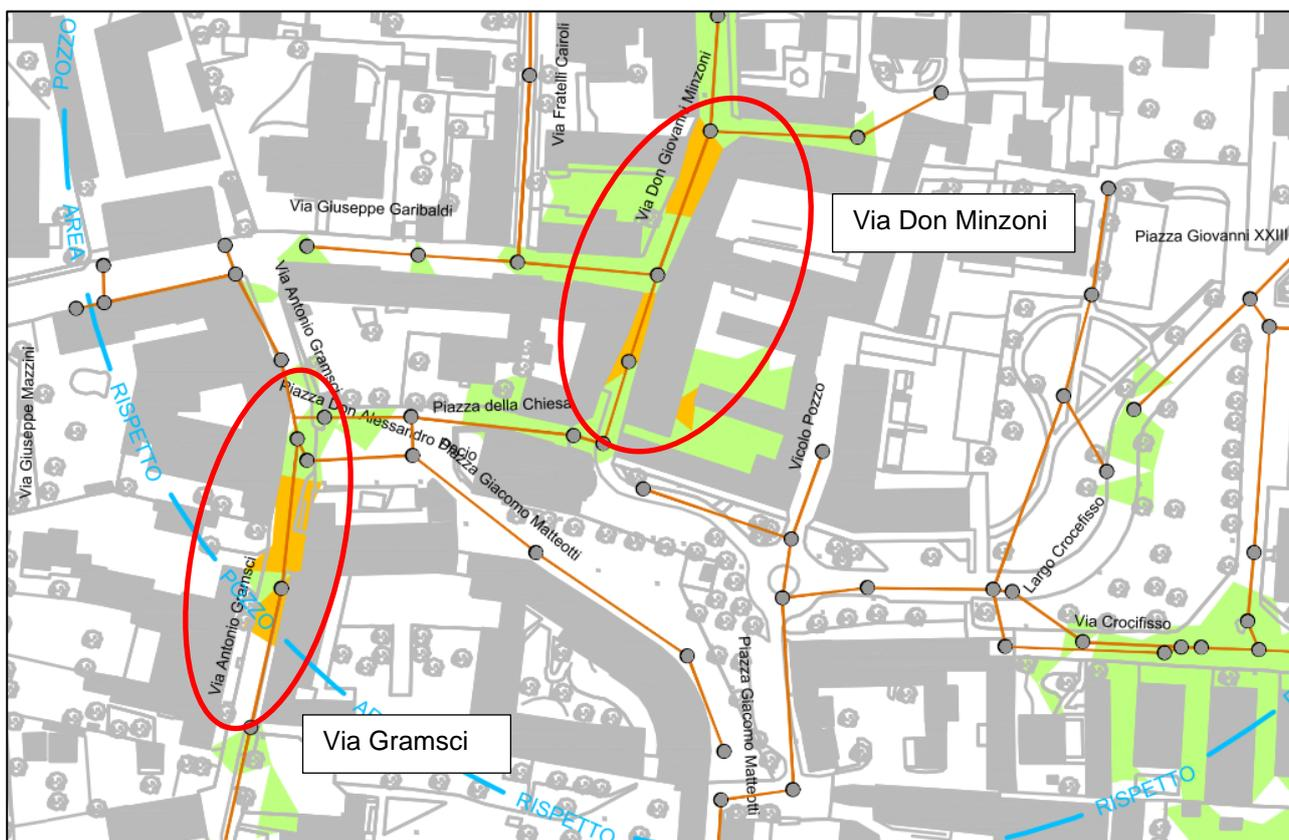
Figura 32: Aree con criticità idraulica T50 in Via Gramsci e Via Don Minzoni
