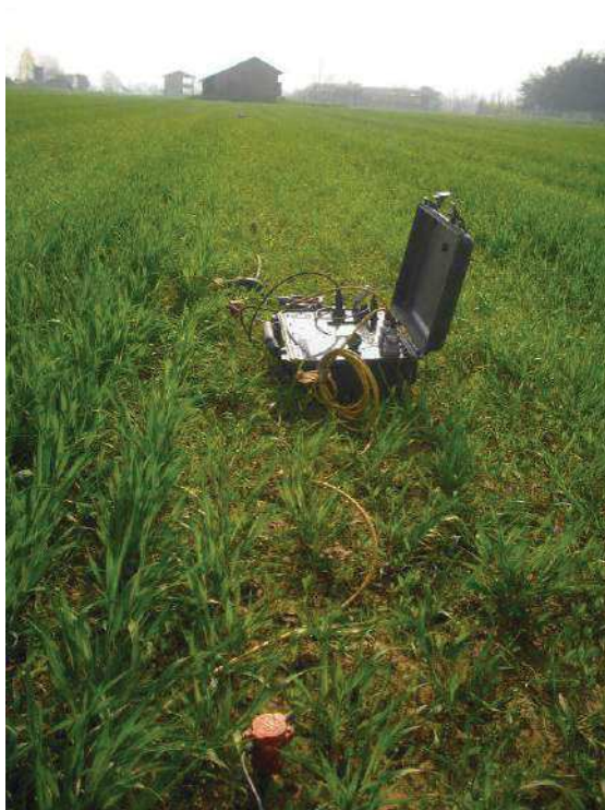
Esecuzione della prova sismica MASW.
